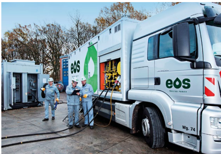
Bild 5. Electrical Oil Services kann mit mobilen Service-Einheiten die Ölaufbereitung oder -regeneration im laufenden Betrieb bei Kunden durchführen.
